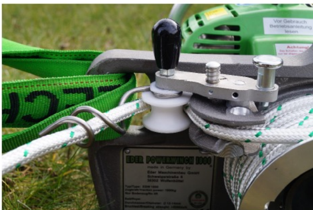
Joonis 6: köie viimine läbi fiksaatori ja juhtvedru
